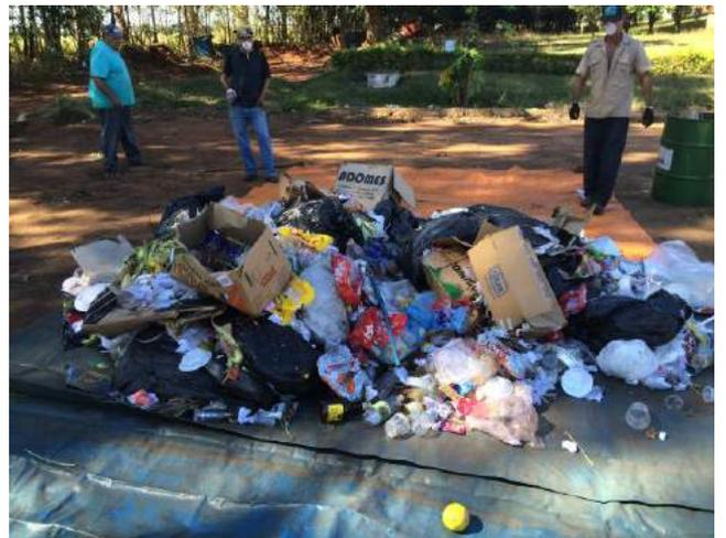
Figura 5: Descarregamento da amostra na lona para determinação da composição gravimétrica.
