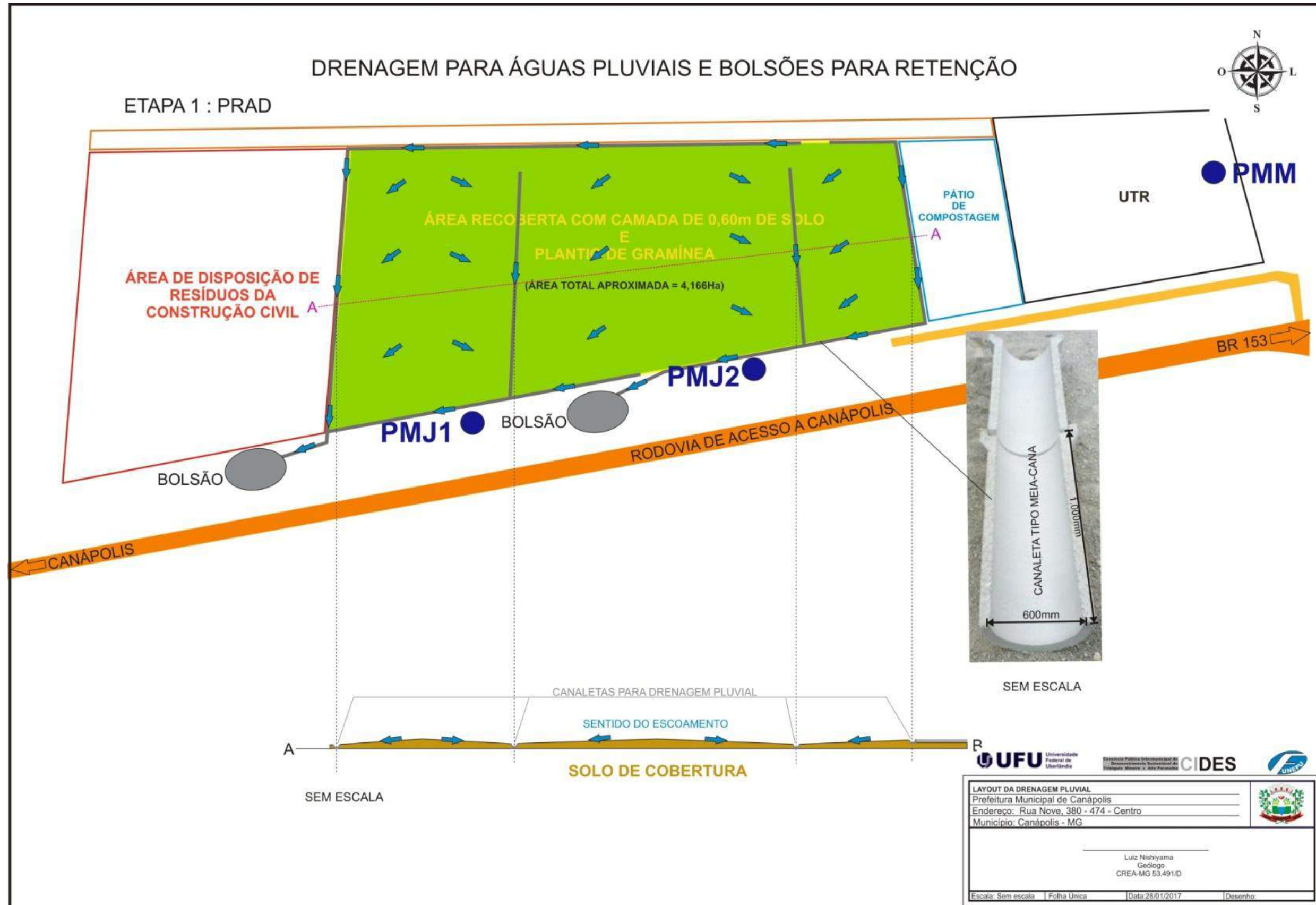
FIGURA 15: Detalhes da rede de drenagem para águas pluviais e bolsões para retenção.
