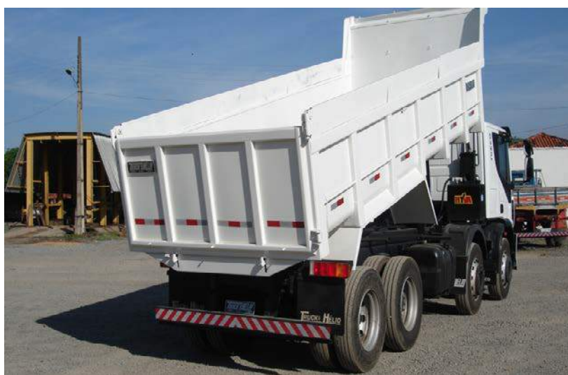
Figura 12: Caminhão caçamba basculante.
