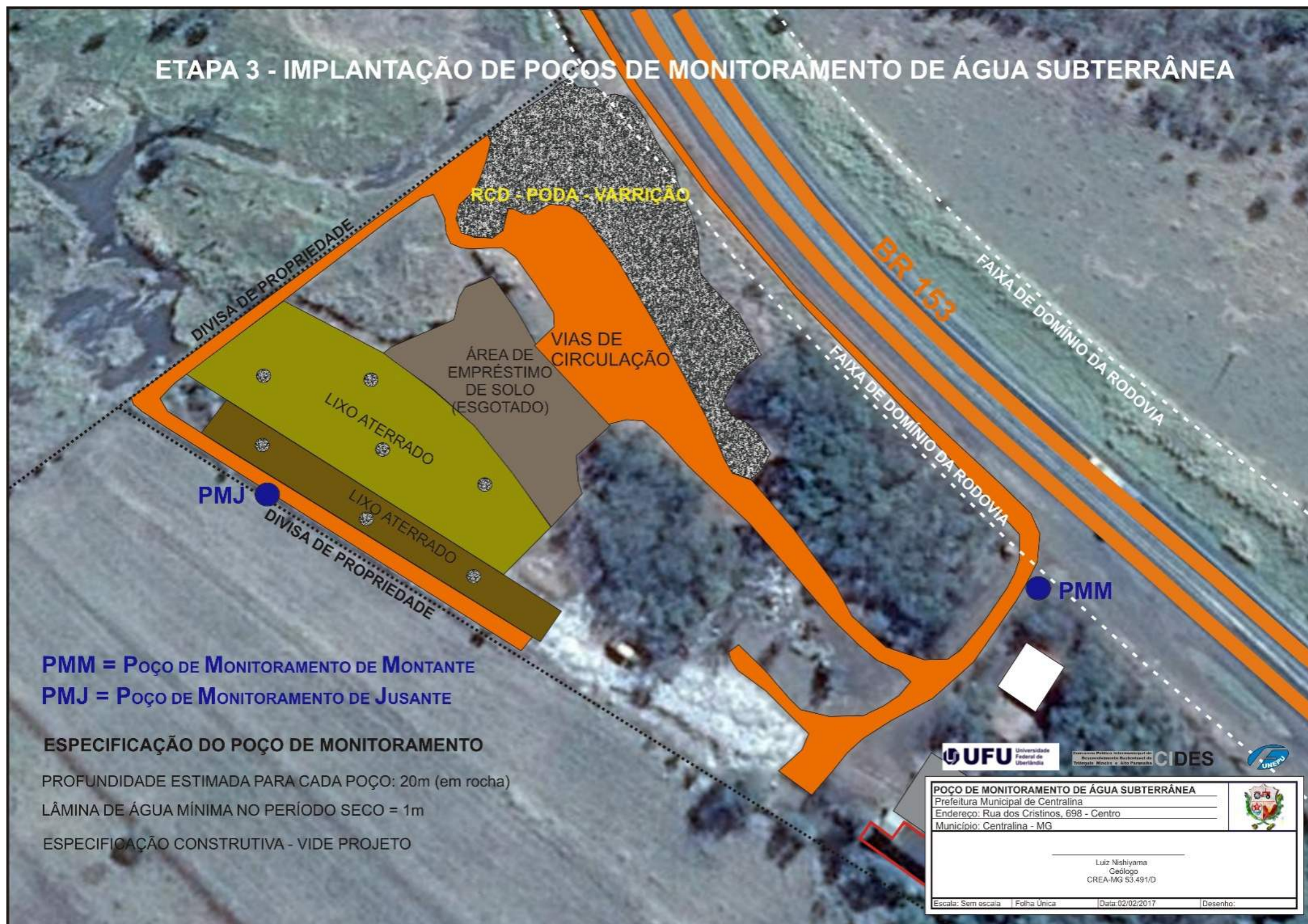
FIGURA19: Implantação de poços de monitoramento da água subterrânea.
