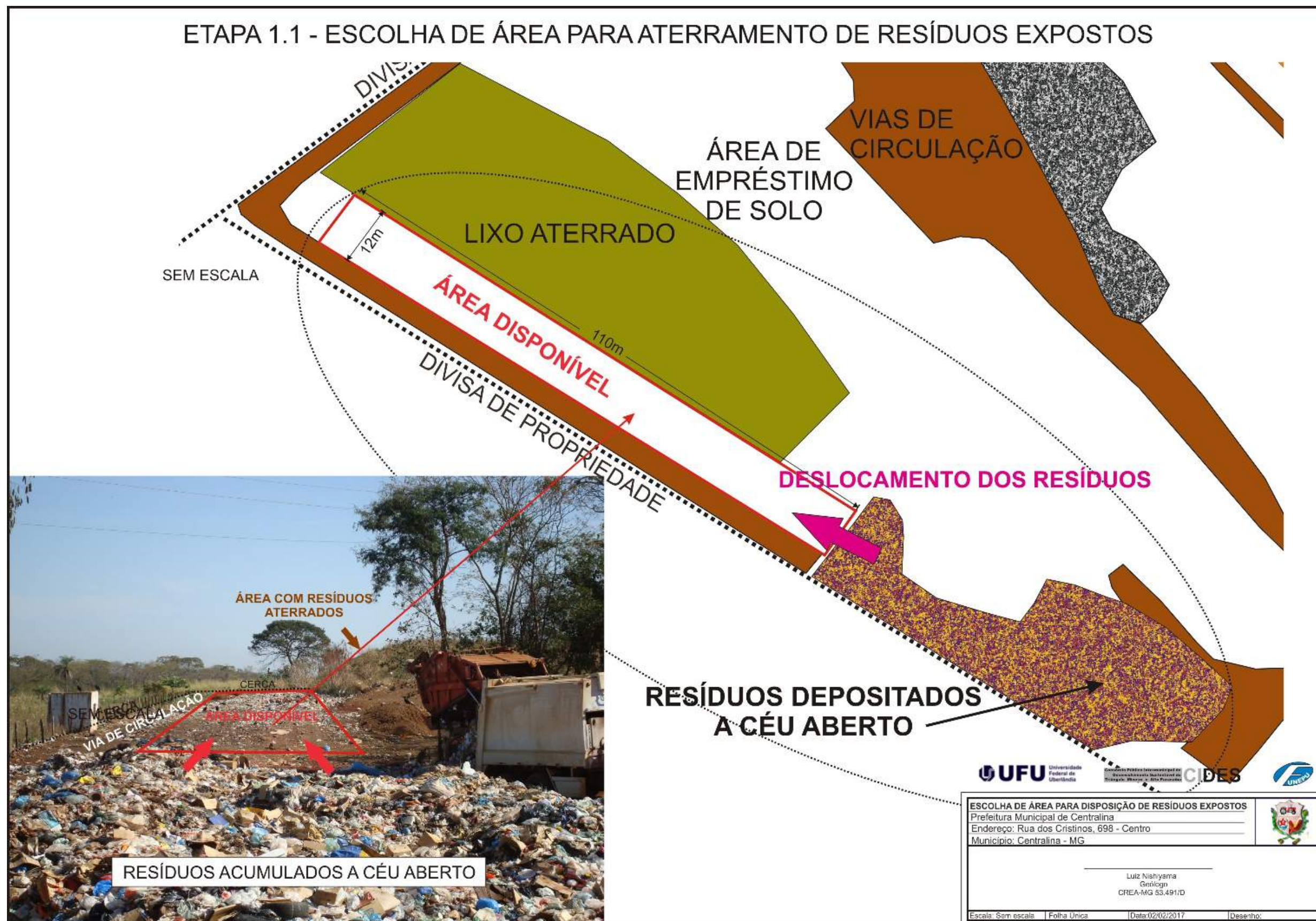
FIGURA12: Definição de uma área para encerramento dos resíduos lançados a céu aberto.
