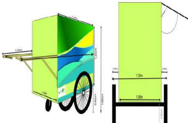
Figura 7: Modelo de carrinho para os catadores de materiais recicláveis.
