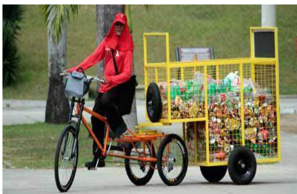
Figura 9: Modelo de carrinho para os catadores de materiais recicláveis.
