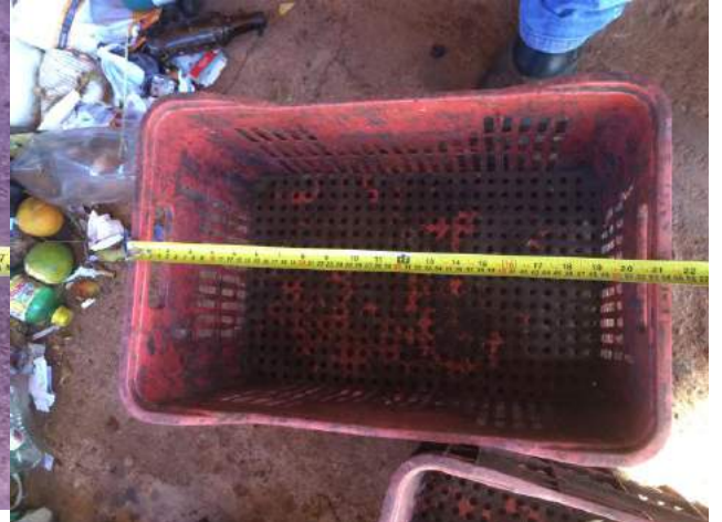
Figura 4: Amostra para determinar peso específico sendo pesada em recipiente com volume conhecido.
