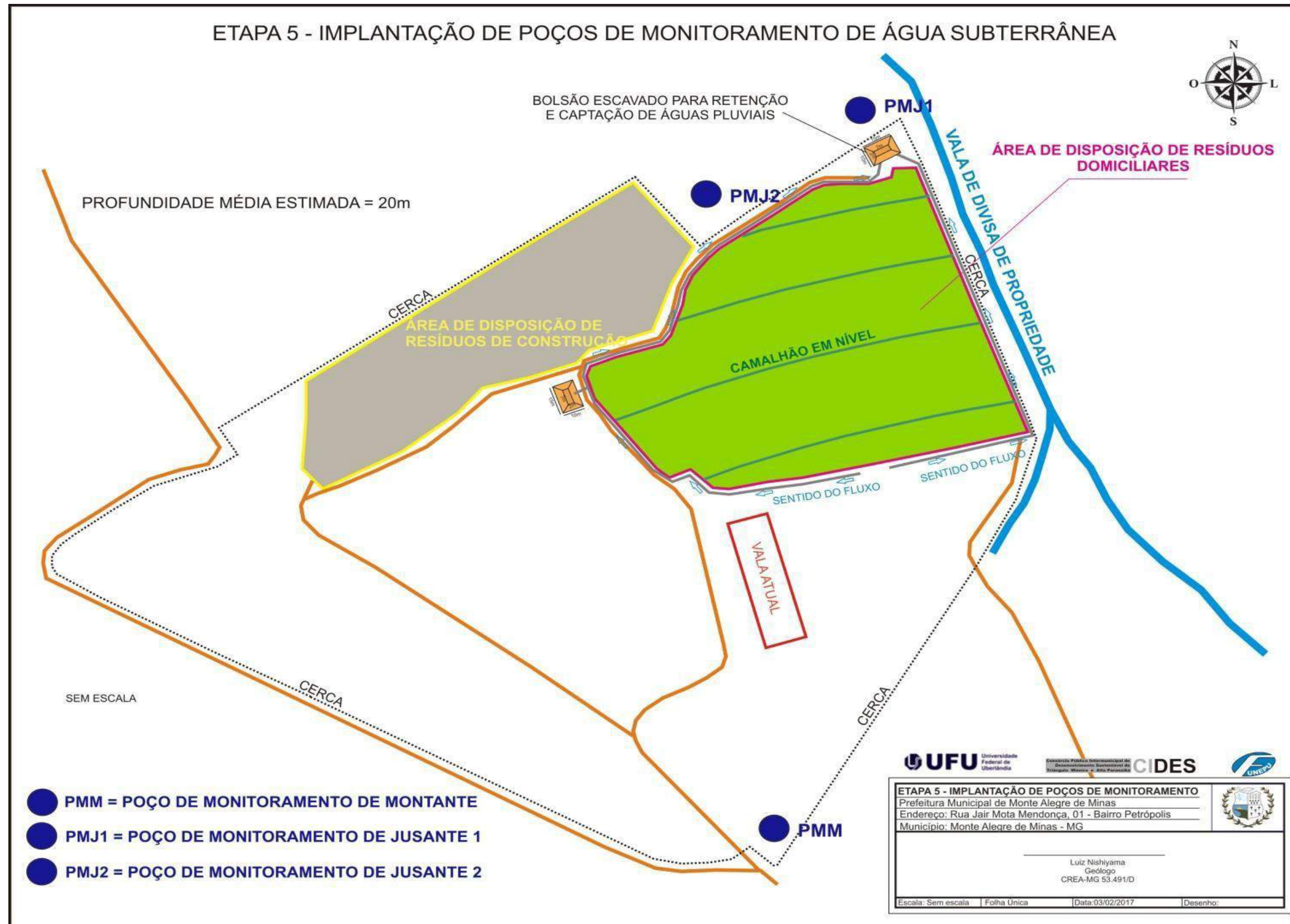
FIGURA 10: Localização dos poços de monitoramento da água subterrânea.
