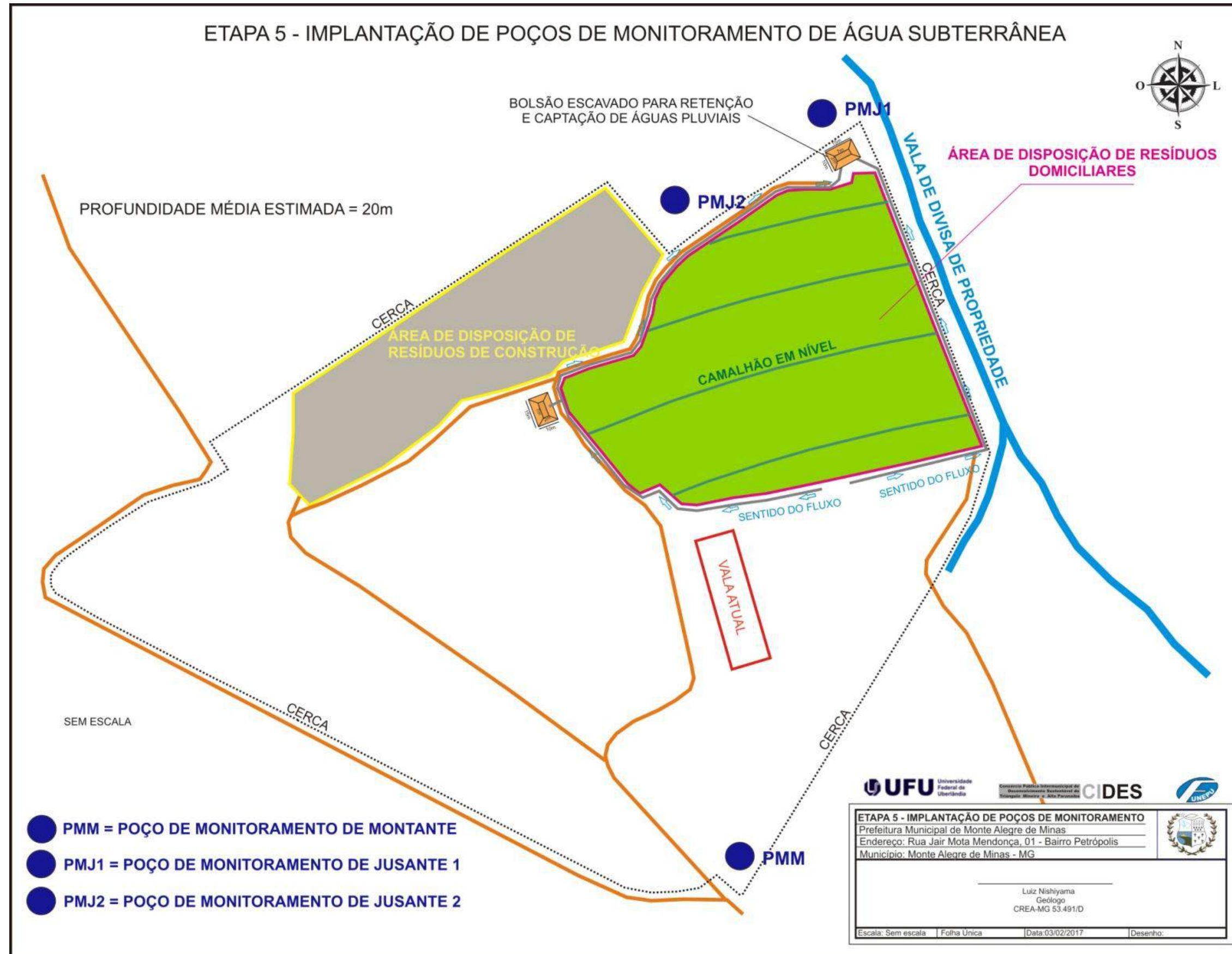
FIGURA 12: Implantação de poços de monitoramento da água subterrânea.
