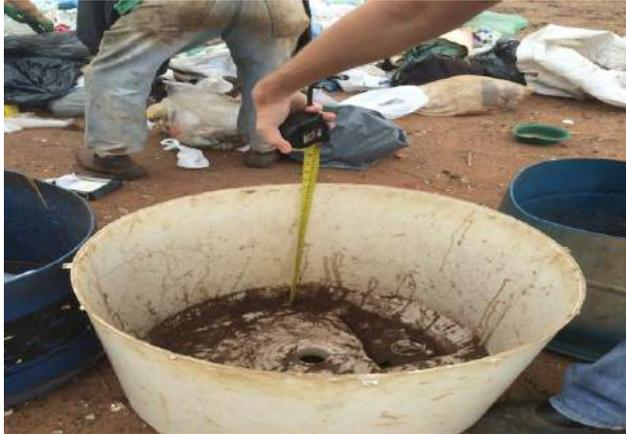
Figura 2: Dimensionando coletor (Diâmetro).
