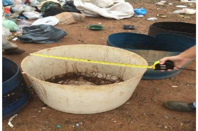
Figura 3: Amostra para determinar peso específico.
