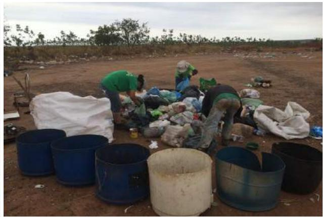
Figura 5: Triagem dos RSU e visão dos recipientes de acumulação.
