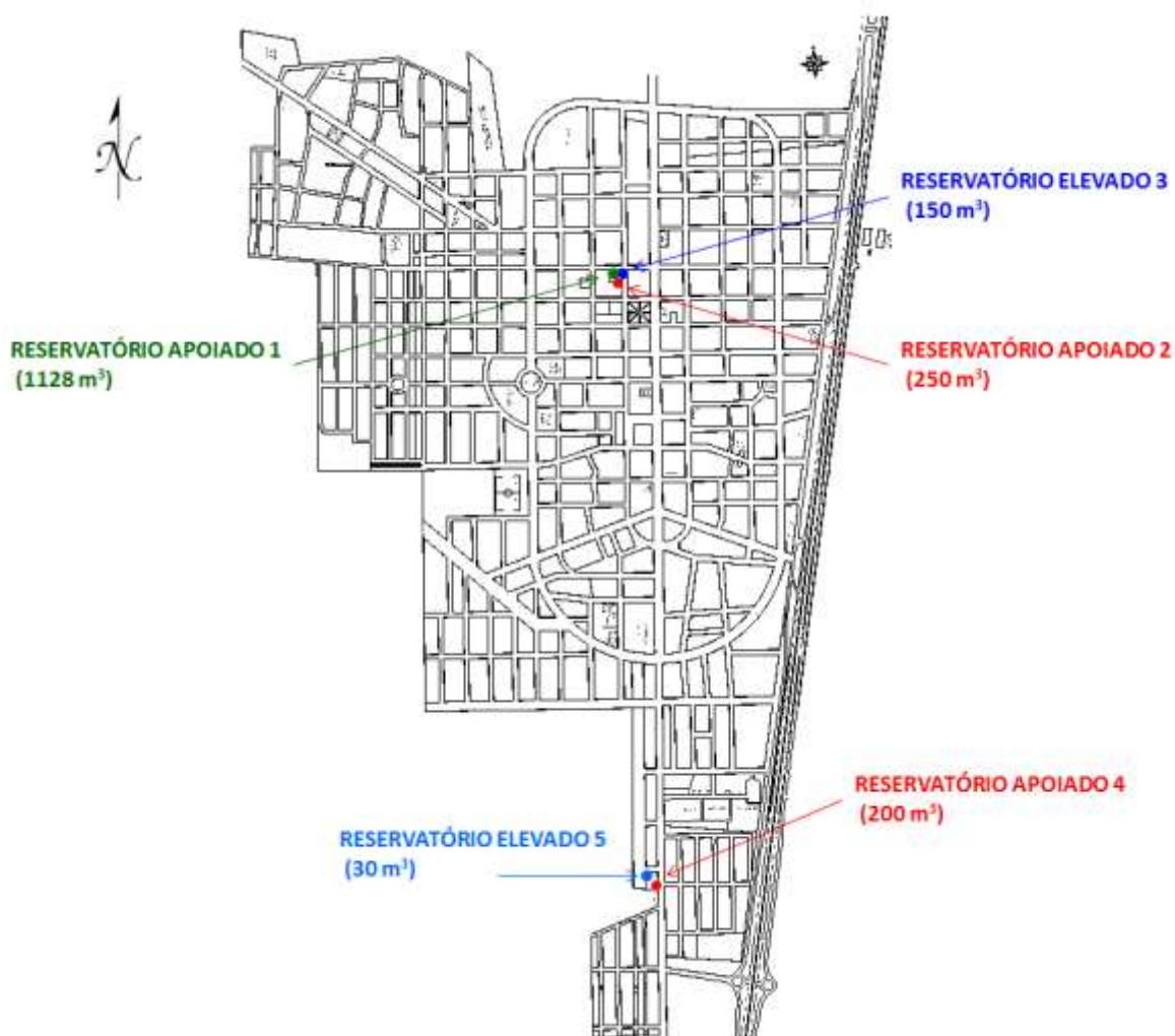
Figura 88: Localização dos reservatórios da cidade de Centralina
