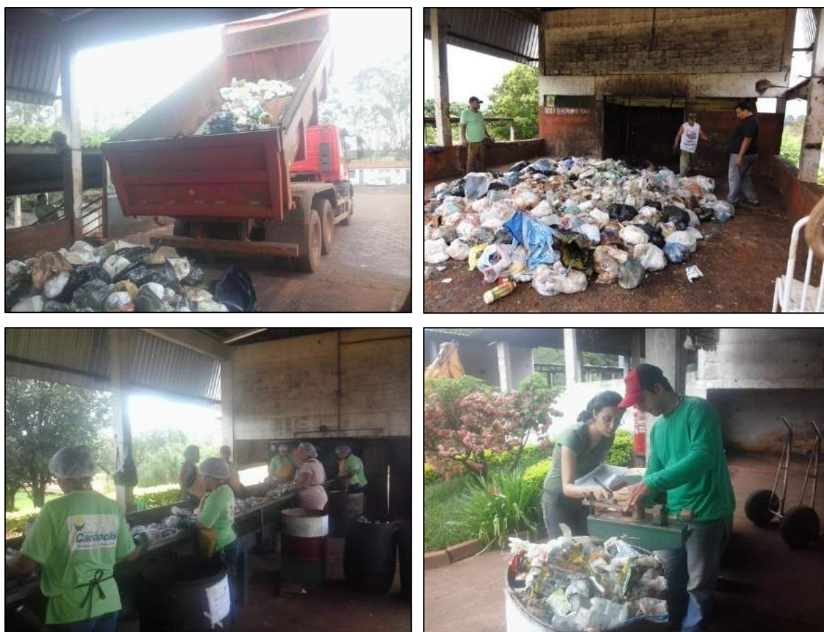
Figura 44: Estudos de gravimetria dos resíduos sólidos domiciliares e comerciais. Amostragem, separação da amostra, segregação e pesagem por tipologia de resíduos.
