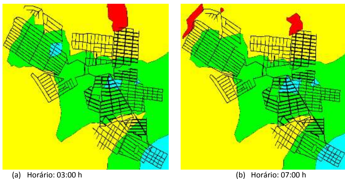
Figura 164: Pressões na rede de distribuição de água considerando o cenário 4
