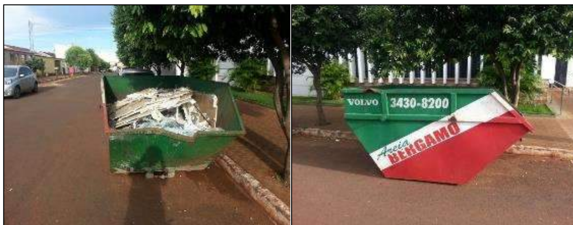
Figura 150: Caçamba de acondicionamento de resíduos de construção civil
