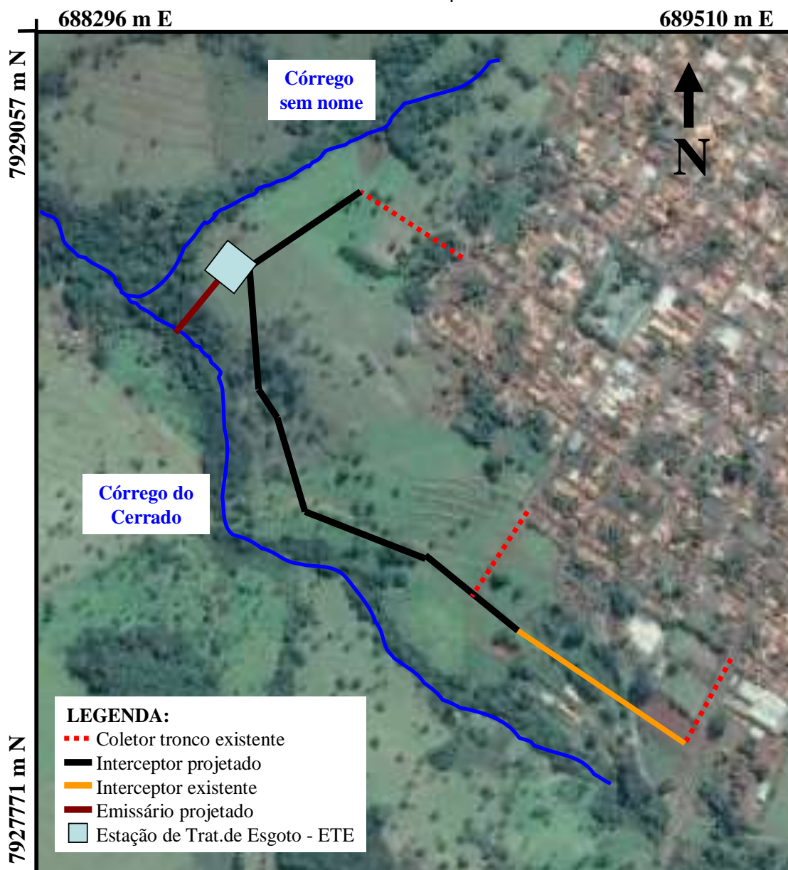
Figura 100: Esquema de localização do interceptor, emissário e ETE na cidade de Canápolis
