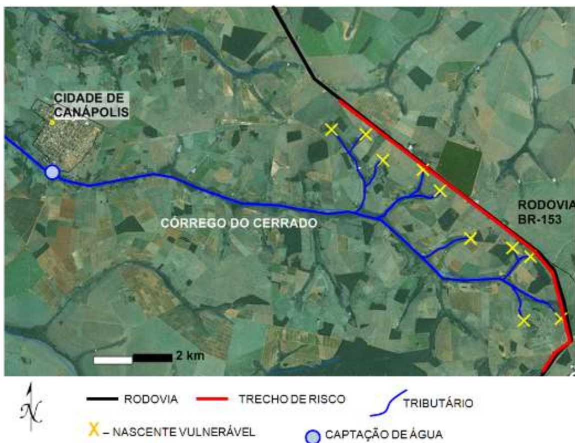
Figura 84: Nascentes vulneráveis a acidentes com cargas perigosas a partir da BR-153
