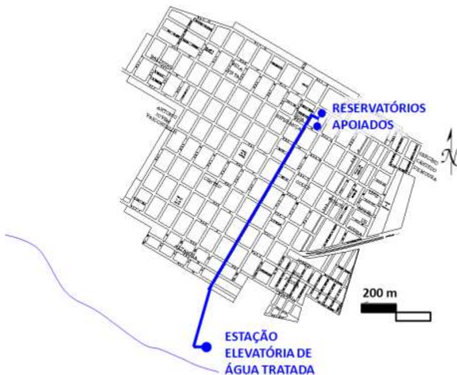
Figura 90: Traçado em planta da adutora de água tratada da cidade de Canápolis
