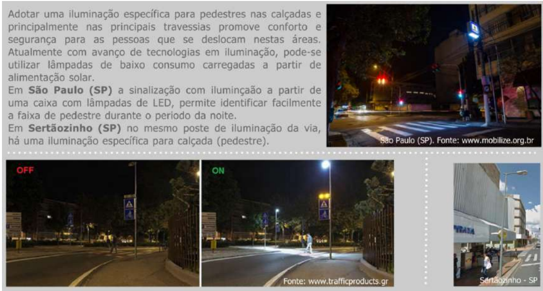
Figura 3-2 Referência de Iluminação Travessia Pedestre.
