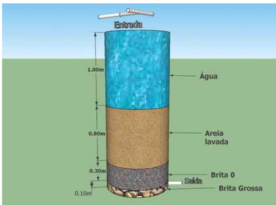
Vista interna do filtro lento
