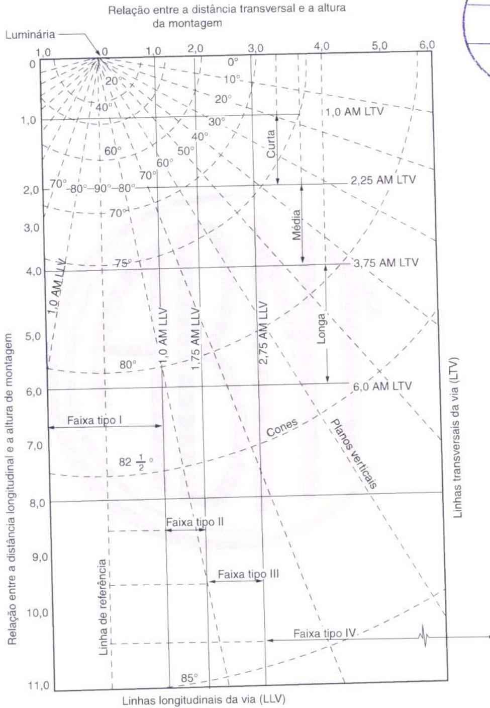
Figura A.6 – Vista em planta de uma via com os diferentes tipos de luminárias
