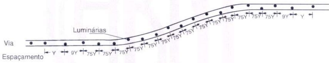
**Figura A.9d – Curva horizontal com raio aproximado de 300 m sobre elevação de 2,0 cm**
