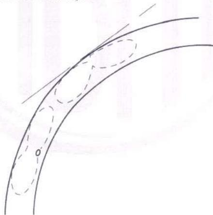
Figura A.9a – Luminárias orientadas de modo que o plano de referência seja perpendicular ao raio de curvatura da curva
