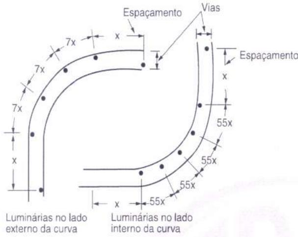
**Figura A.9b – Curvas horizontais de pequeno raio**
