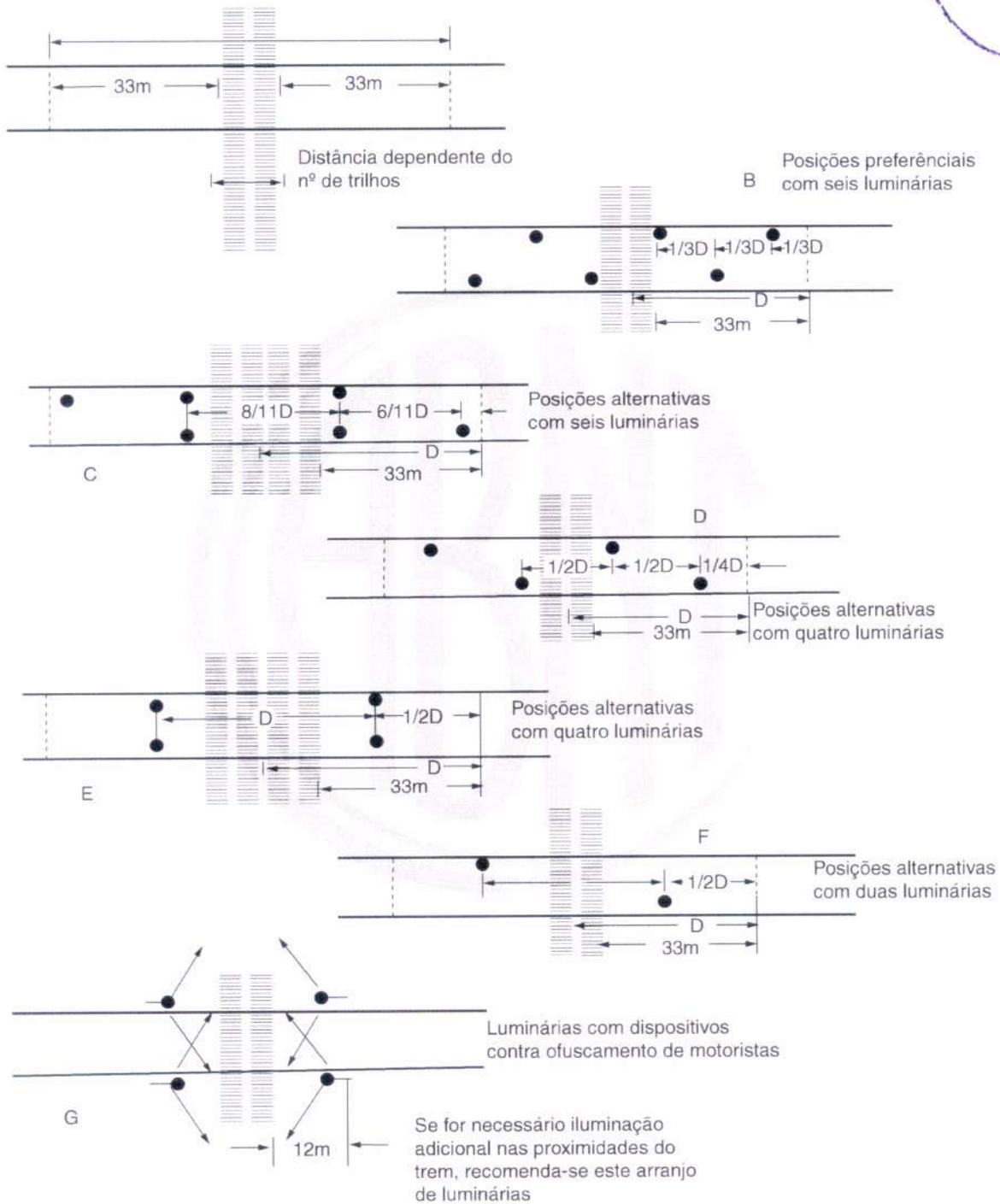
Figura A.11 – Cruzamento em nível com ferrovias
